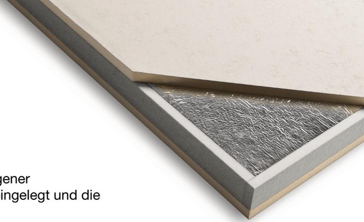
Deck-VQ ist eine Vakuumdämmplatte (VIP) auf Basis pyrogener Kieselsäure. Der Kern wird in eine mehrlagige Folienhülle eingelegt und die Vakuumdämmplatte wird allseitig mit einer hochdichten Wärmedämmplatte (PIR) ummantelt
